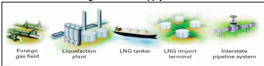
Figure 1: LNG Supply Chain
